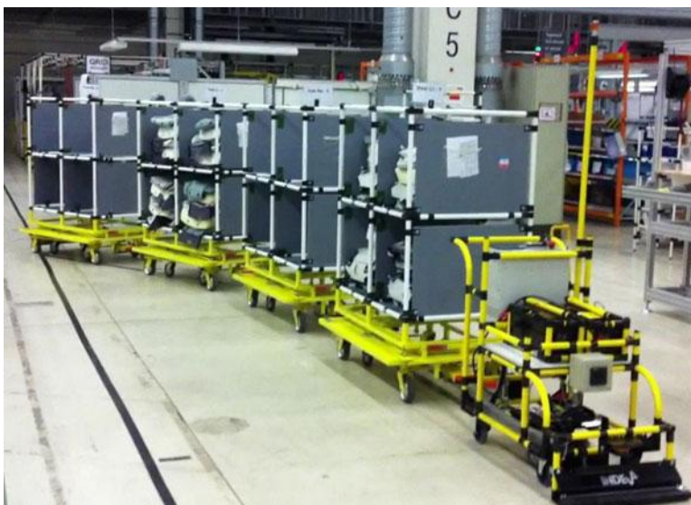
Figura 12: Exemplo de um AGV transportante objetos dentro de uma fábrica.
